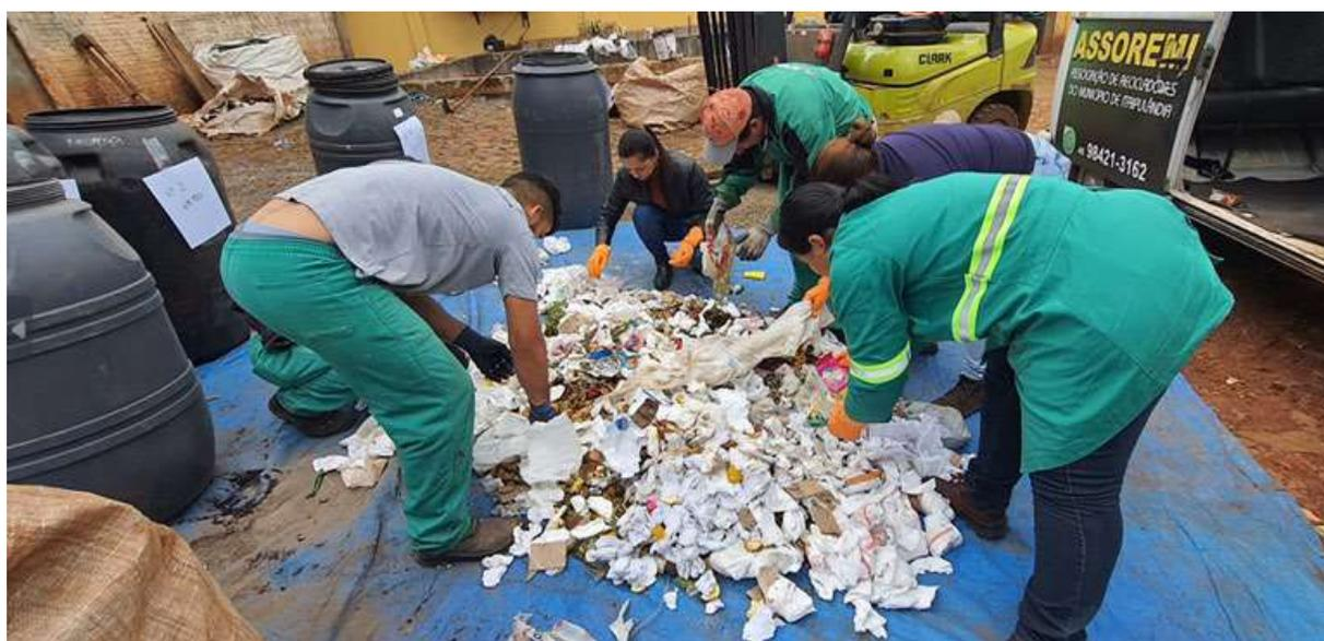
**Figura 65: Amostra misturada e separada segundo sua tipologia (3ª etapa)**
