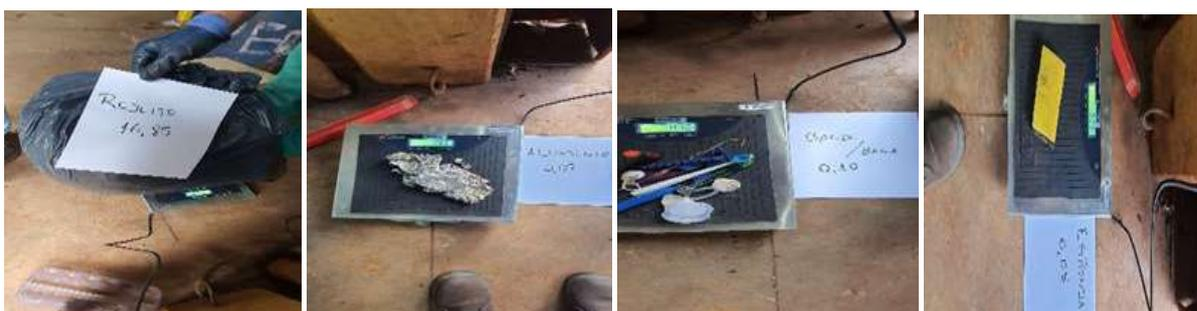
**Figura 67: Amostra separada e pesada segundo sua tipologia (3ª etapa)**
